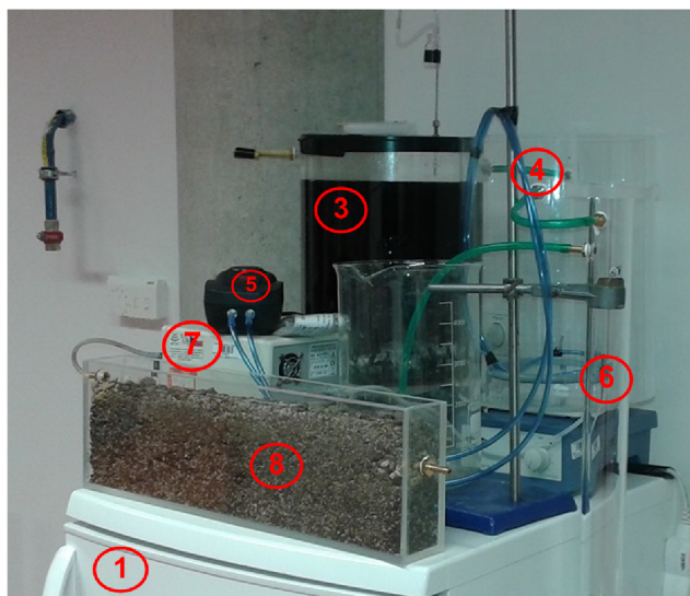
Obrázek 3: Fotografie laboratorní aparatury modelu mokřadního systému.
