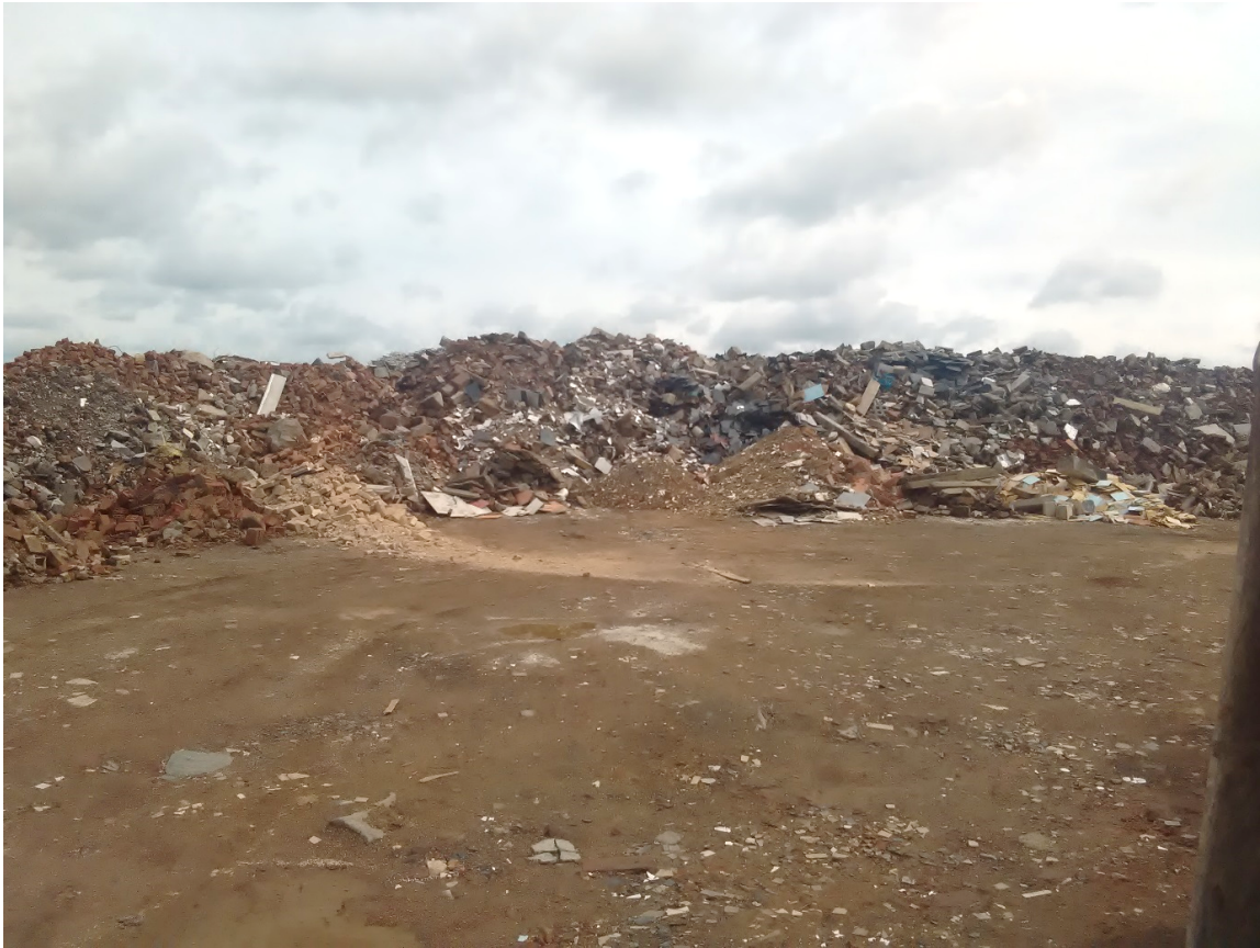
Abbildung 2: Ungebrochenes Bauschuttmaterial mit hohem Ziegelanteil auf einer Halde
