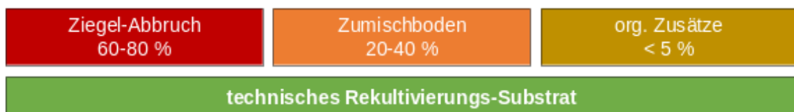
Abbildung 9: Substratanteile der künstlichen Rekultivierungsschicht
