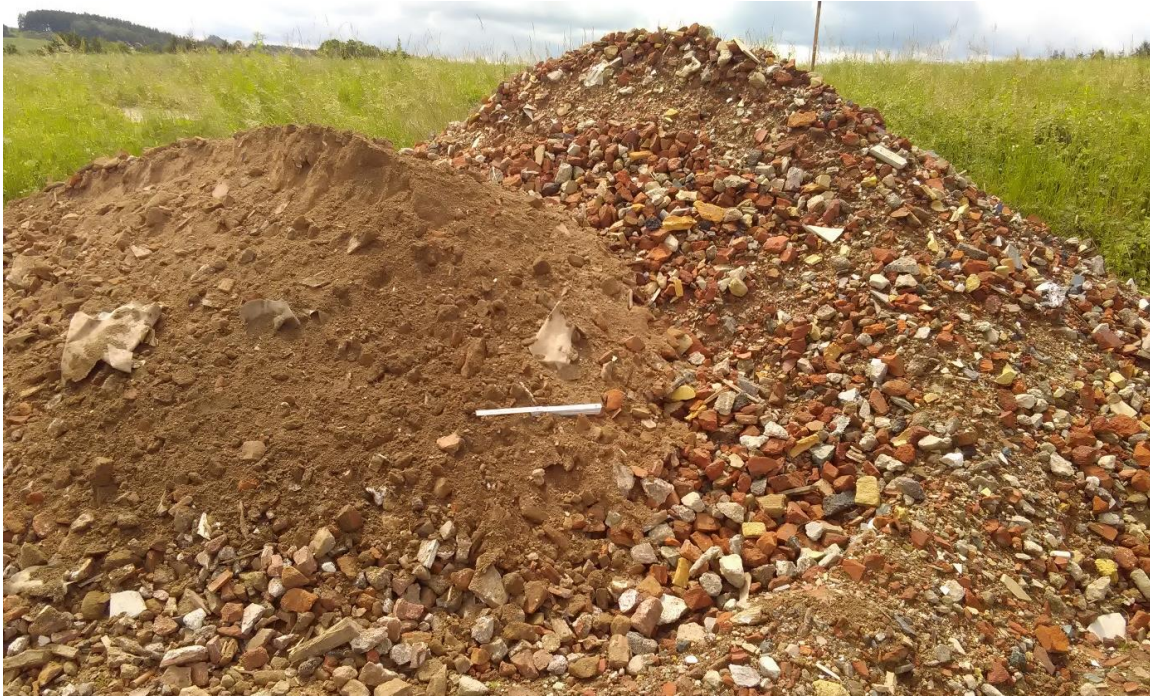
Abbildung 4: Halde aus 0/63 mm Ziegel-RC mit frisch abgeladenen Material links und älteren Material rechts
