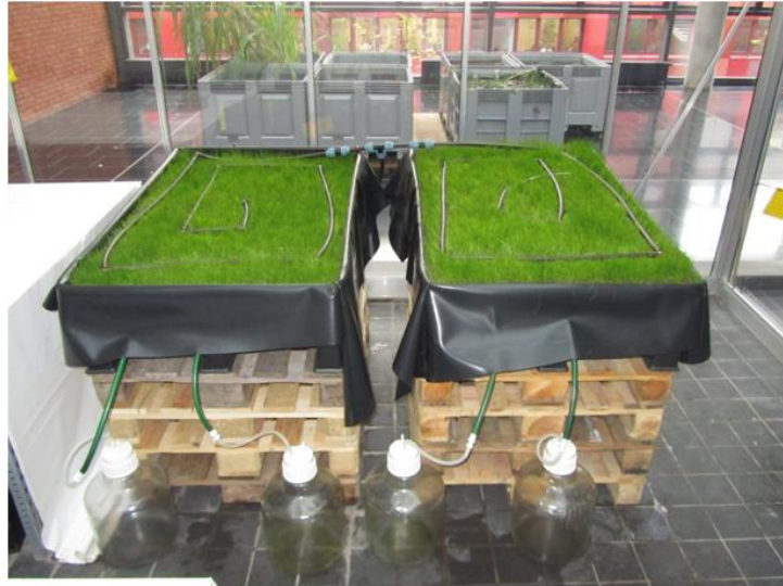
Abbildung 1: Testsysteme zur Untersuchung alternativer Abdichtungssysteme (links Kontrollsystem, rechts Testsystem mit alternativer Abdichtung)
