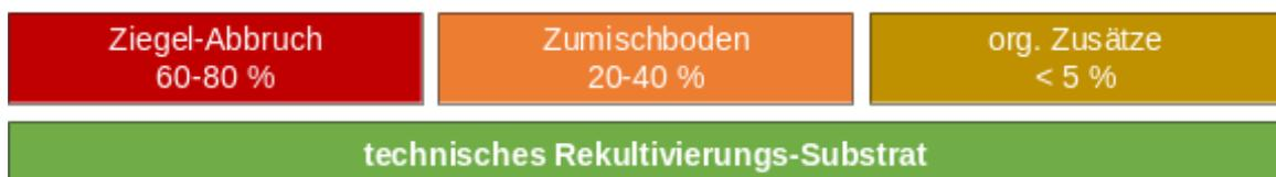
Abbildung 9: Substratanteile der künstlichen Rekultivierungsschicht
