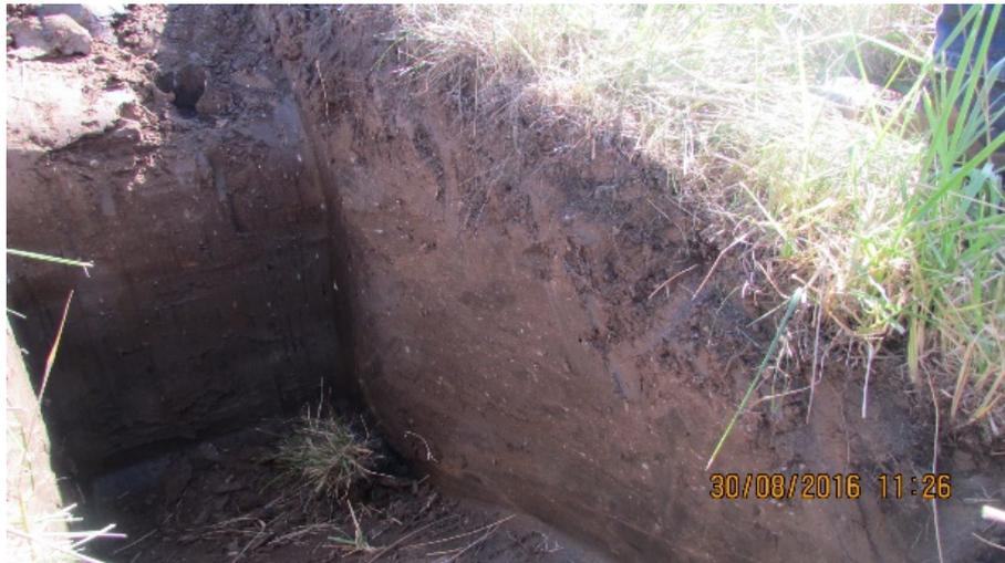
Abbildung 5: Deponie Spremberg-Cantdorf: Aufgrabung der Wasserhaushaltsschicht fünf Jahre nach Herstellung
