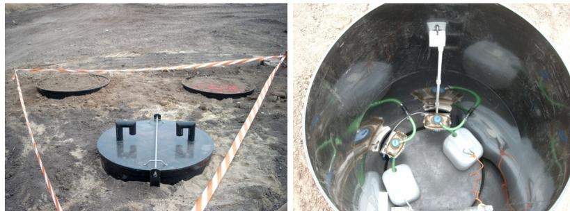
Abbildung 10: Nichtwägbare Lysimeter zur Eignungsbewertung unterschiedlicher Materialien für die Abdeck- und Rekultivierungsschicht (links) mit Sickerwasserschacht (Deponie Gunsleben).
