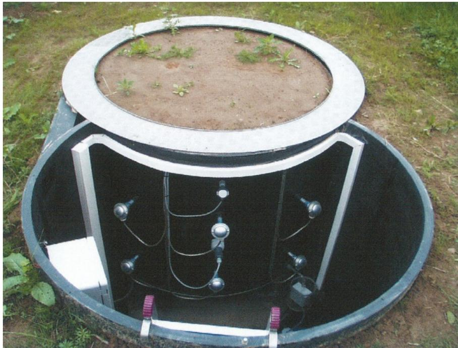
Abbildung 8: Wägbares Lysimeter ausgestattet mit bodenhydrologischer Messtechnik zur Wasserhaushaltsüberwachung (Deponie Kassel-Baunatal).
