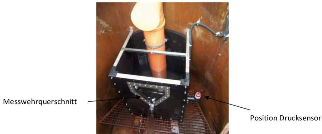
Abbildung 3: Aufbau eines spezifisch angepassten Messwehrs zur Messung der Abflusshöhen.
