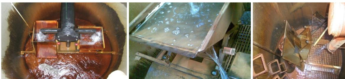
Abbildung 2: Beanspruchung der Kippzähler durch belastetes Wasser und hohe Abflussraten.
