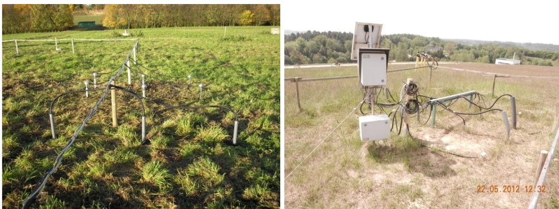
Abbildung 12: Bodenhydrologischer Messplatz mit Wetterstation zur Deponie-Überwachung (links: Deponie Rheinberg, rechts: Deponie Rastorf).
