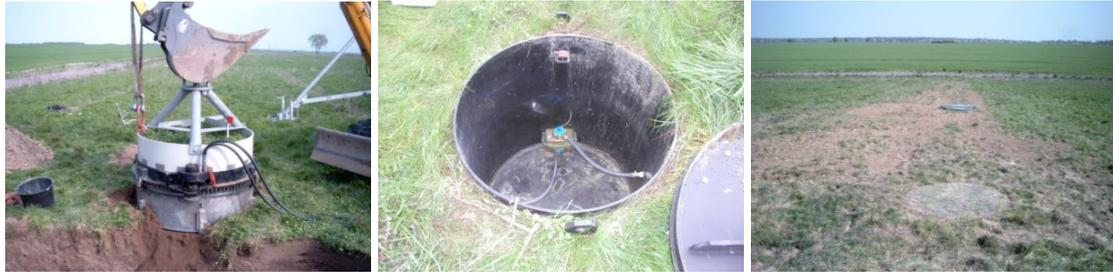
Abbildung 9: Entnahme eines ungestörten Bodenkörpers zur Überwachung der Funktionalität der Abdeckschicht (links) mit Installation Sickerwasserfassung und Kippzähler (Mitte) (Deponie Emden).
