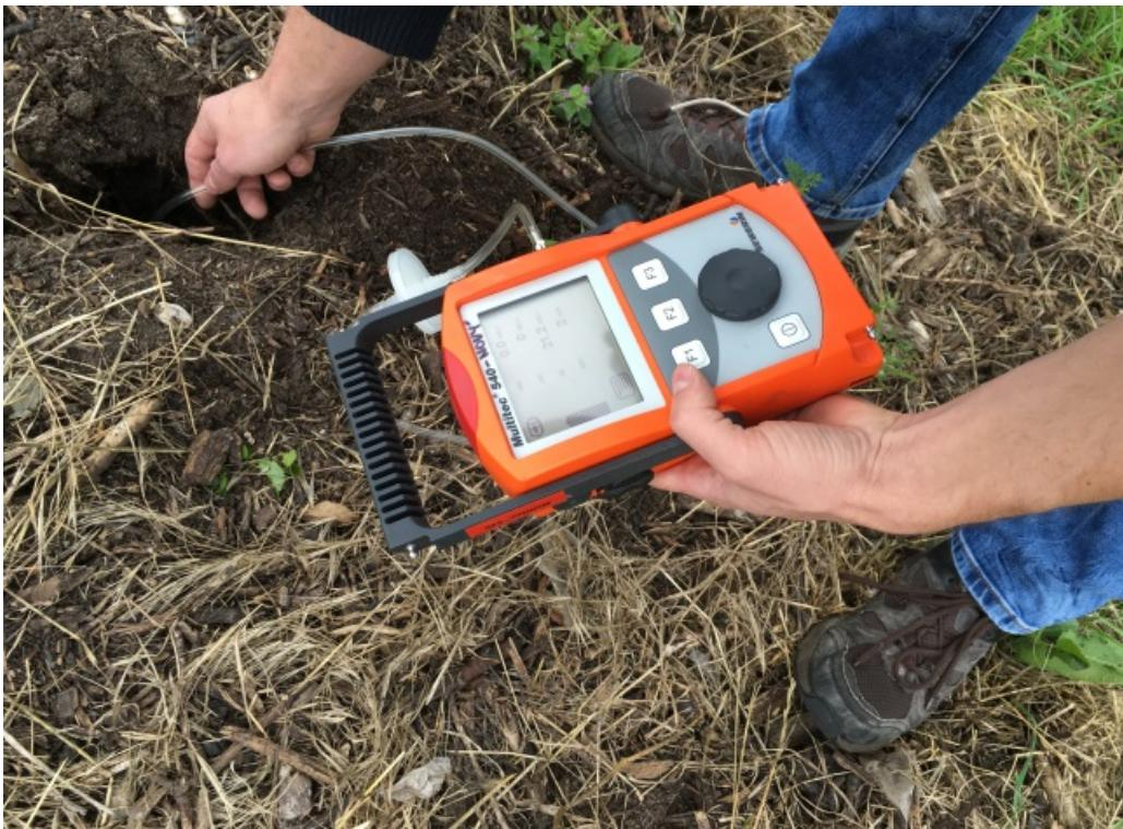
Obrázek 6: Methanometr Sewerin Multitec 540.
