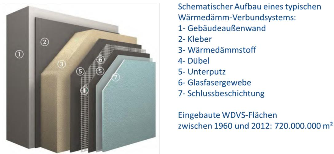
Abbildung 10: Bestandteile eines Wärmedämmverbundsystems, Quelle: Fraunhofer-Institut für Bauphysik IBP, 2015.
