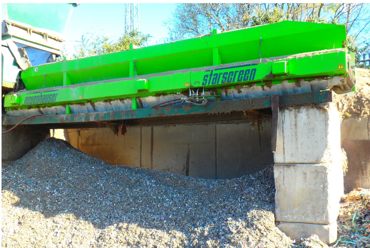
Obrázek 6: Stacionární hvězdicový třídič fy. Neuenhauser Maschinenbau GmbH pro RDF.
