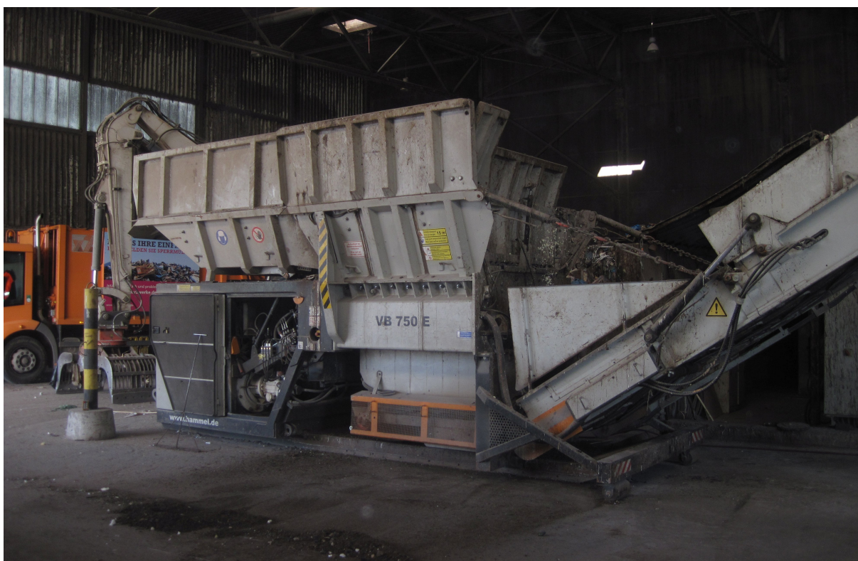
Obrázek 3: Stacionární elektrický dvouhřídelový drtič fy. Hammel VB750E u firmy Remondis.
