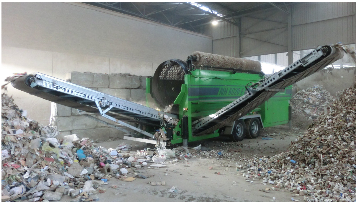
Obrázek 5: Bubnový třídič fy. Neuenhauser Maschinenbau GmbH s elektrickým pohonem.
