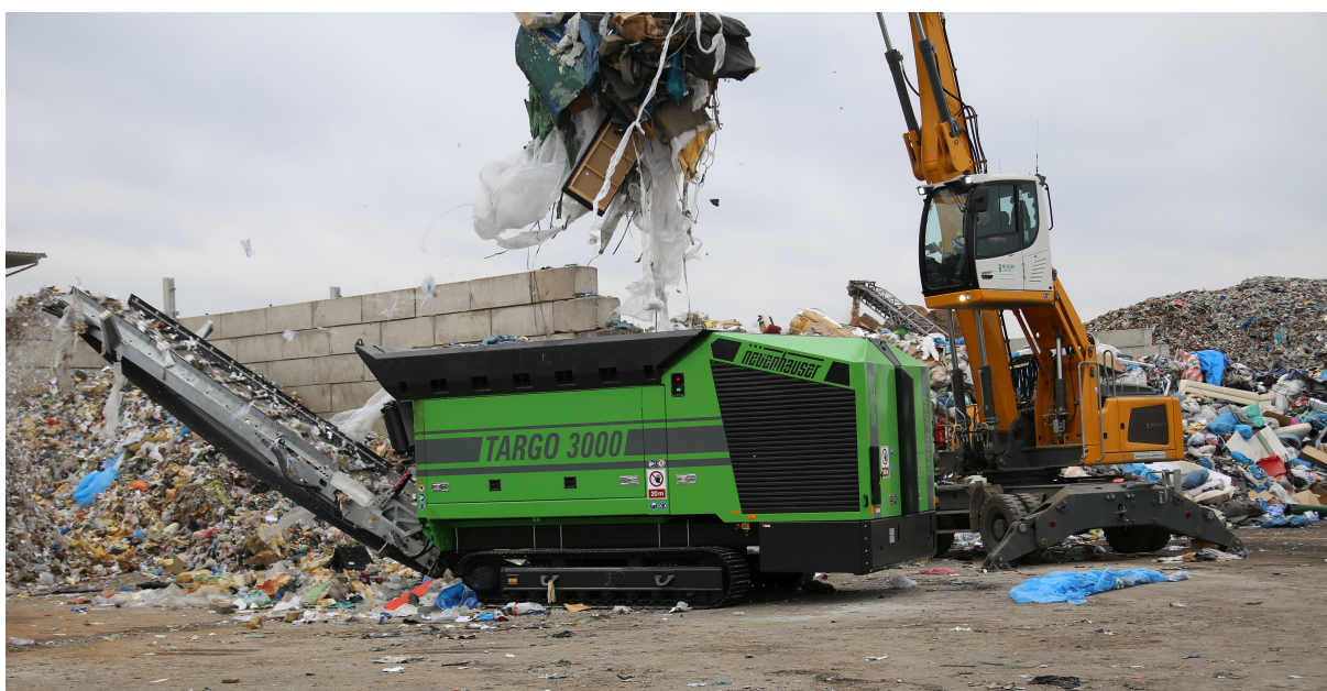
Obrázek 4: Drcení odpadů jednohřídelovým drtičem TARGO 3000.
