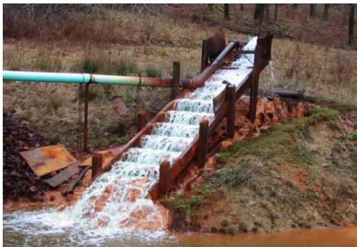
Obrázek 4: Gravitačná kaskáda na prevzdušnenie.
