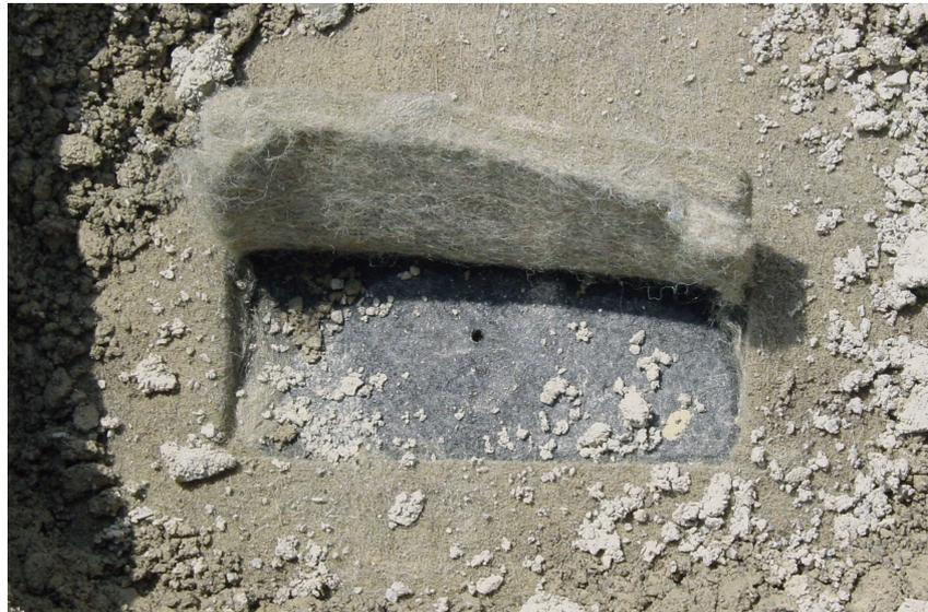
Abbildung 10: Das Schutzgeotextil wurde für die Funktionsprüfung wieder über das Testloch geklappt. Das Wasser wurde über das Geotextil abgeführt und gelangte nicht durch das Testloch.
