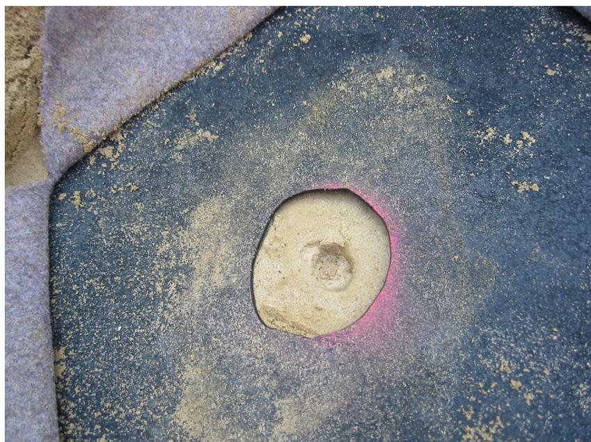
Abbildung 9: An diesem ausgeschnittenen Testloch ist klar zu erkennen, dass unterhalb der Testleckage ein Hohlraum entstanden ist, der einen Stromfluss durch die Testleckage verhindert.
