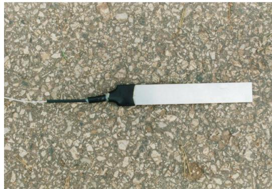
Abbildung 2: Spannungsgeber.
