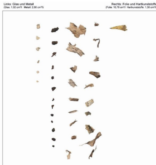
Abbildung 1: Beispiel ausgelesener Fremdstoffe aus einem Liter Prüfsubstrat. Gehalt an Gesamtfremdstoffen: 0,43 Gew.-%, Flächensumme: 22 cm 2 /l FM
