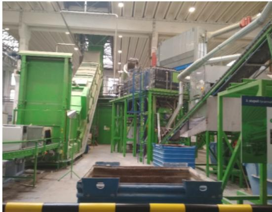
Zařízení ke zpracování EEZ (použité lednice), drcení plastů a separace kovů ve Stráži pod Ralskem
