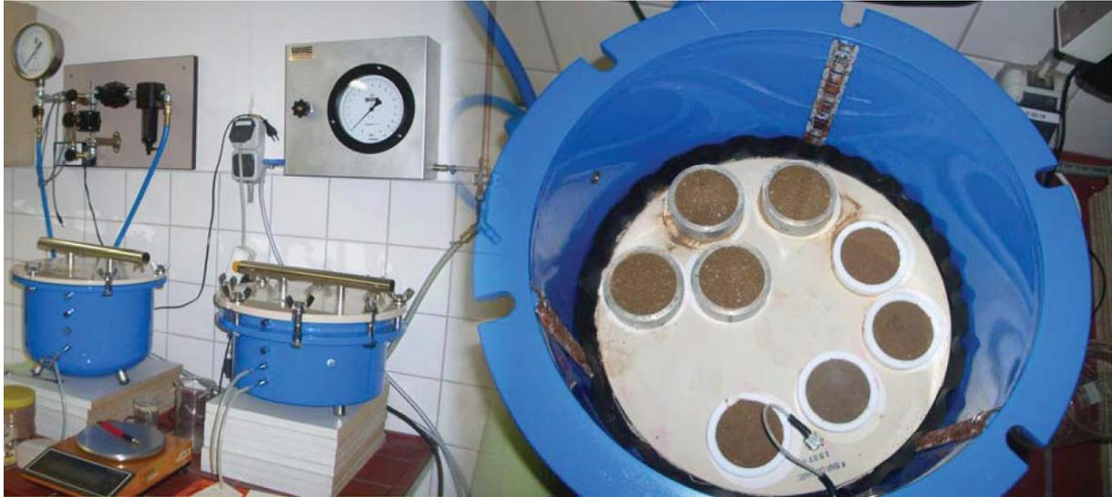
Abbildung 8: Proben im Druckplattengerät zur Bestimmung der nutzbaren Feldkapazität.
