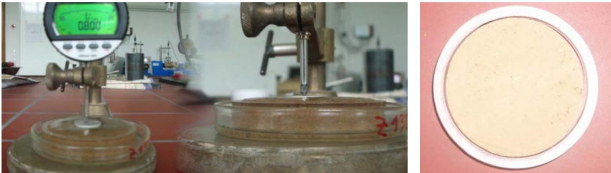
Abbildung 9: Quellen (links) und Schrumpfen (rechts) bei der nFK-Bestimmung.
