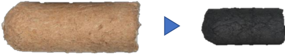
Abbildung 5: Beispielhaftes Aussehen und Volumenänderung der agglomerierten Biomasse (links) durch den Pyrolyseprozess zu einem geformten Adsorbens (rechts).
