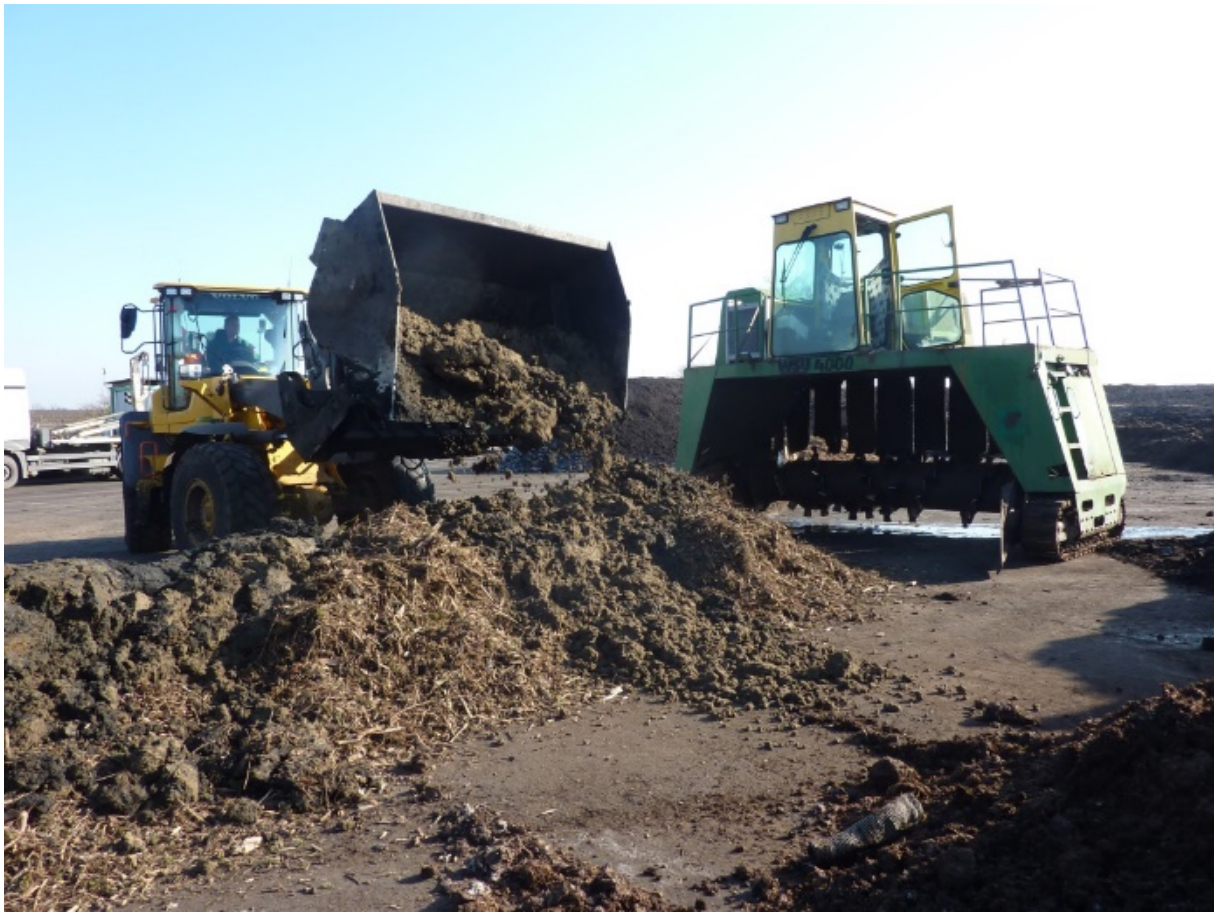
Abbildung 1: Aufsetzen einer kleintechnischen Kompostmiete.
