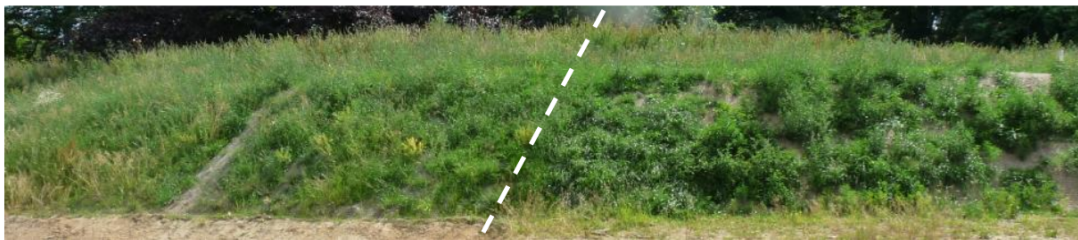
Abbildung 4: Zustand der begrünten Erosionsschuttmatten je vier verschiedener Typen nach ca. 3 Monaten Wachstumsdauer (linke Hälfte Anspritzbegrünung Gräser, rechte Hälfte Ansaat Lupinen).
